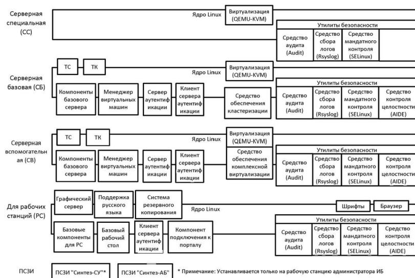
Рис. 4. Модульный состав семейства операционных систем «Синтез-ОС»
